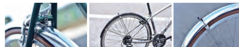
前後の吊り金具はステンレス製なので各種取り付けボルトが豊富で取り付けがスムーズ シルバーカラーはアルミ膜を透明のポリカーボネート樹脂でサンドすることで金属の質感を100%再現しながら、軽さと耐久性を両立。サングラスにも使用される透明度の高いポリカーボネートの性能を活かした設計です。
