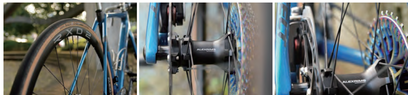
カーボンリムより軽い400gの超軽量リム。30mmハイトと内幅19mmで剛性にも優れます ストレートフルハブ採用。ハイローフランジでスポークテンションを均一化 0.95mm極薄エアロスポークによるエアロダイナミクスで高速ロードレースに対応。
