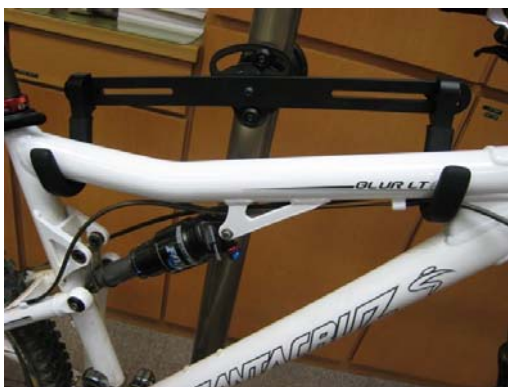
調整可能なバイクハンガーのアーム角、幅。
